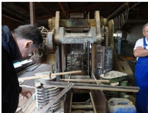
Schärfmaschine für die Bandsägeblätter
