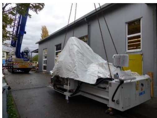
Unsere neue CNC wird mit einem Kran abgeladen
